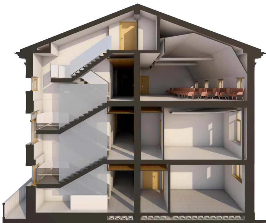
Come si approfondisce più innanzi, la parziale riduzione del solaio di sottotetto strutturalmente costituisce un miglioramento perché diminuisce la massa, a patto però che venga garantito il comportamento di piano rigido, affiancando all'intervento della riduzione del solaio in latero cemento, una adeguata operazione di cerchiatura e tirantatura dello stesso.
